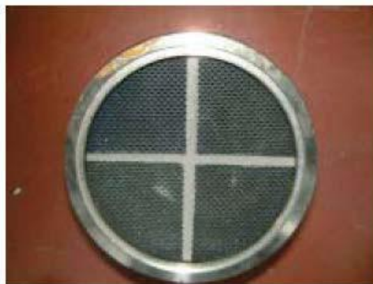
Fig 9. Udløbssiden af et brugt filter
