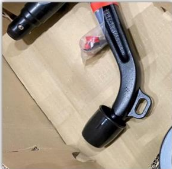
Billede 1 - Den aftagelige del af tilkoblingsanordningen med beslag til sprængwire
