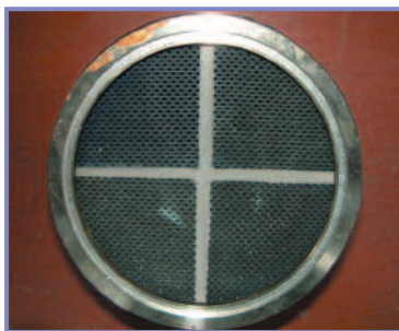
Figur 17 - Udgangsoverflade på et brugt filter
