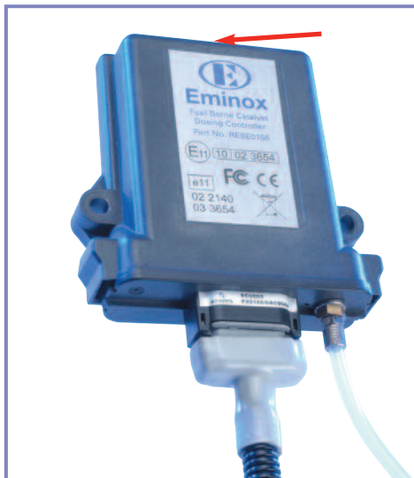
Figur 13 – Placering af reedafbryder
