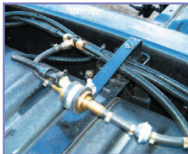
Figur 7a (venstre) & 7b – placering af samling ved indsprøjtningsted
