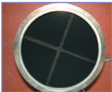
Figur 16 - Indgangsoverflade på et brugt filter
