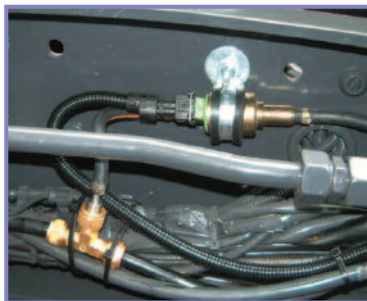
Figur 7a (venstre) & 7b – placering af samling ved indsprøjtningsted
