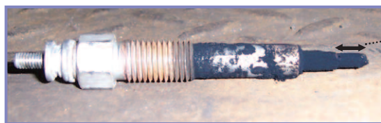
Figur 5 viser en normalt slidt spids
