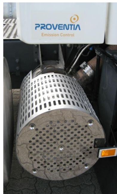
Fig 4. Et eksempel på en Proventia PROAIR-installation på en Volvo-lastbil.
