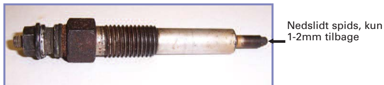
Figur 6 viser et nedslidt gløderør
