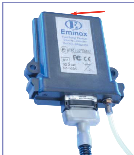
Figur 13 – Placering af reedafbryder
