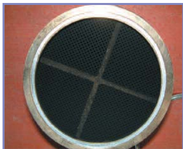
Figur 16 - Indgangsoverflade på et brugt filter
