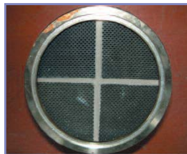
Figur 17 - Udgangsoverflade på et brugt filter
