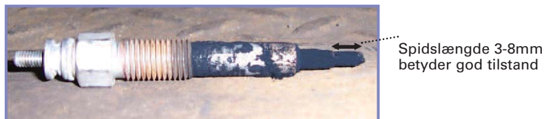
Figur 5 viser en normalt slidt spids
